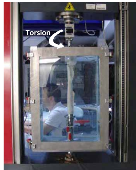
Abb. 2: Setting zur Druck-Verformungsanalyse von Blutgefäßen.
